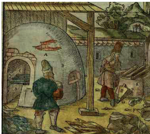
A lengyel és magyar leűzőkemence ábrázolása a De re metallicában (10. könyv. 243. ábra)
