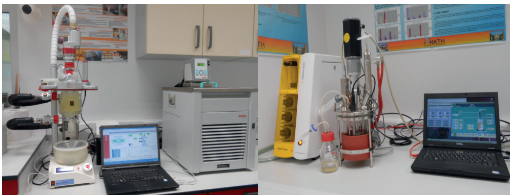
3. ábra: Az in vitro emésztési modell első szakaszát, vagyis a kémiai emésztést a bal oldali ábrán bemutatott készülékben végeztük el. A jobb oldali ábrán pedig a Biostat A+ fermentor látható, melynek segítségével a vastagbélben lejárló folyamatokat modelleztük.
